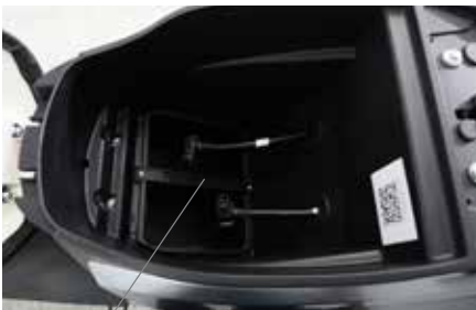
VANO BATTERIA CON BATTERIE ESTRATTE
