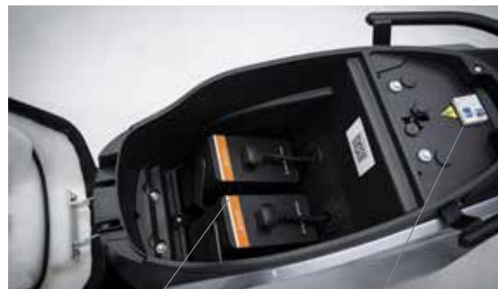
BATTERIE DA 60V 24AH DISPOSTE NEL VANO SOTTO SELLA
