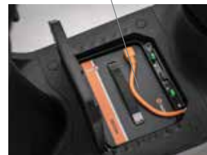
VANO BATTERIA APERTO
