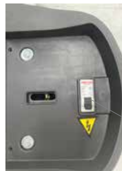
INTERRUTTORE GENERALE OFF
